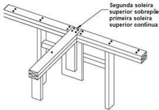
Figura 4.14 – Detalhe de soleira dupla em intersecção de paredes [adaptado de WFCM for One- and Two- Family Dwellings (2015)]
