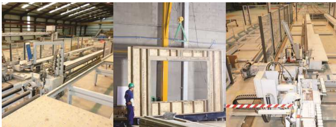
Figura 4.1 – Paredes em Wood Frame sendo executadas em ambiente industrial. [adaptado de TECVERDE(20--)]
