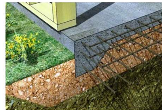
Figura 24 - Representação do radier de concreto
