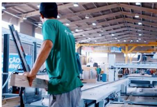
Figura 7 - Colaborador alimentando a linha automatizada com peças de madeira estrutural tratada
