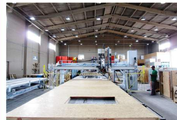
Figura 9 - Painel Estrutural com frames montados, OSB chapeado e janelas cortadas
