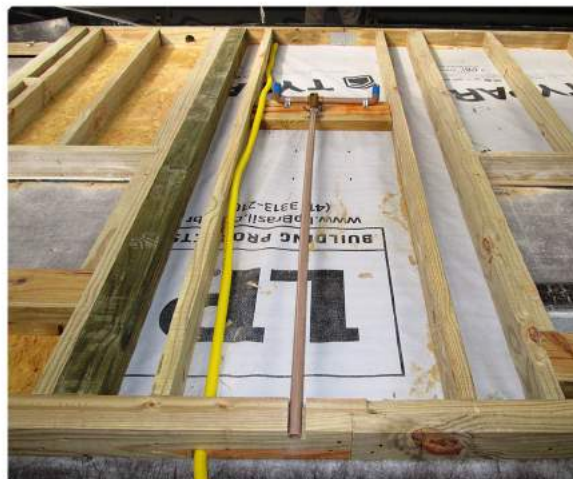
Figura 29 – Kit hidráulico já fixado no painel durante processo fabril
