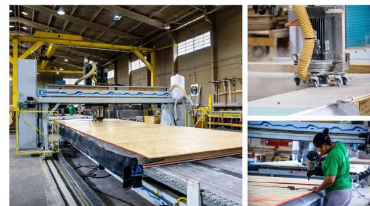
Figura 19 – Chapeamento do OSB e cortes do vão para janelas Fonte: Tecverde Engenharia S/A
